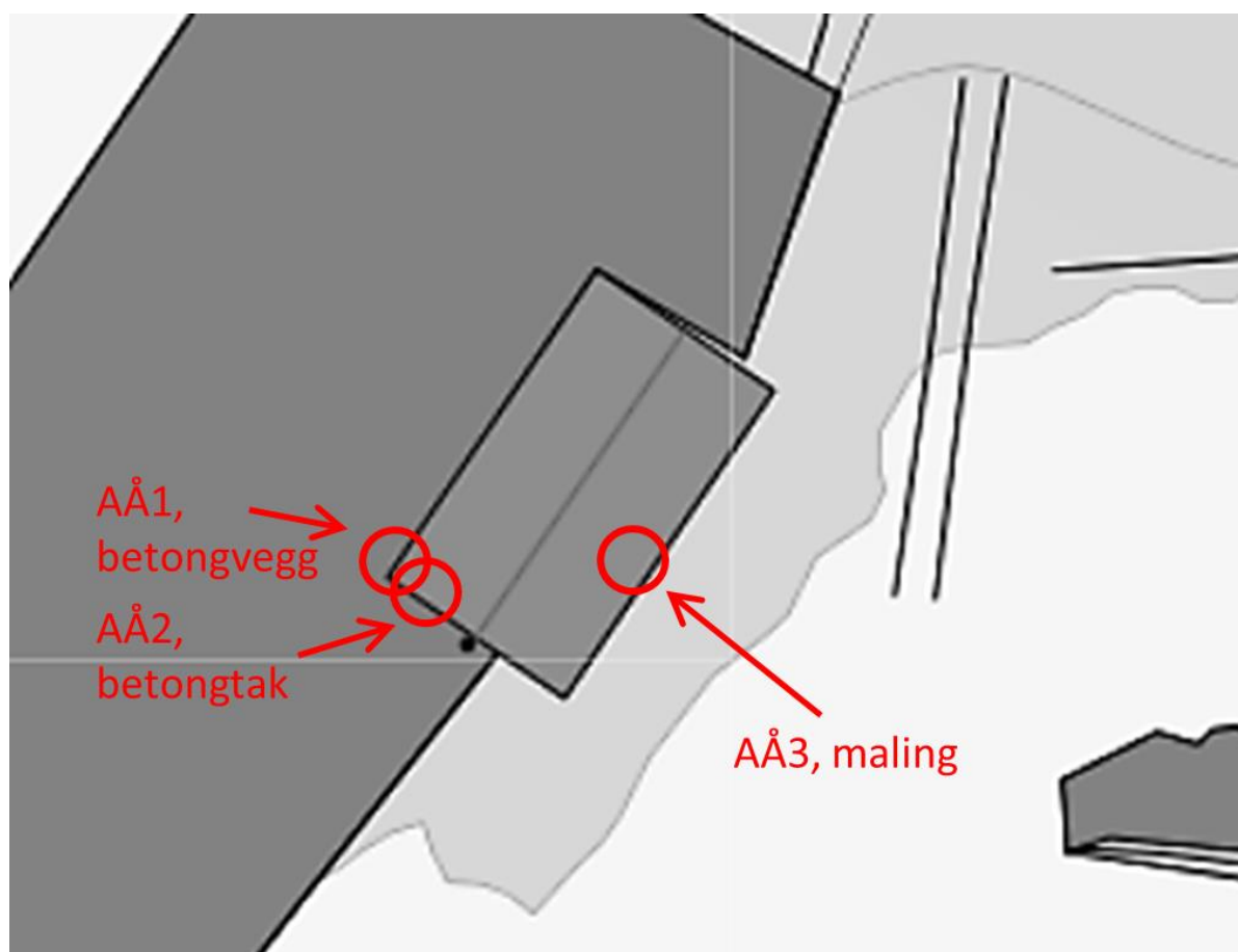
Figur 12. Oversikt over prøvelokasjoner for venteskuret på Austre Åmøy. Prøvene ble analysert for metaller, PCB og Cr6. Analysene påviste forurensning av Cr6 i betong. Malingsprøven hadde konsentrasjoner under normverdi.
